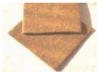
Figura 22 – Pantalla biodegradable de coco ([http://www.agrariaverde.pt/geosinteticos/geotextil\\_biomanta.pdf](http://www.agrariaverde.pt/geosinteticos/geotextil_biomanta.pdf)).
